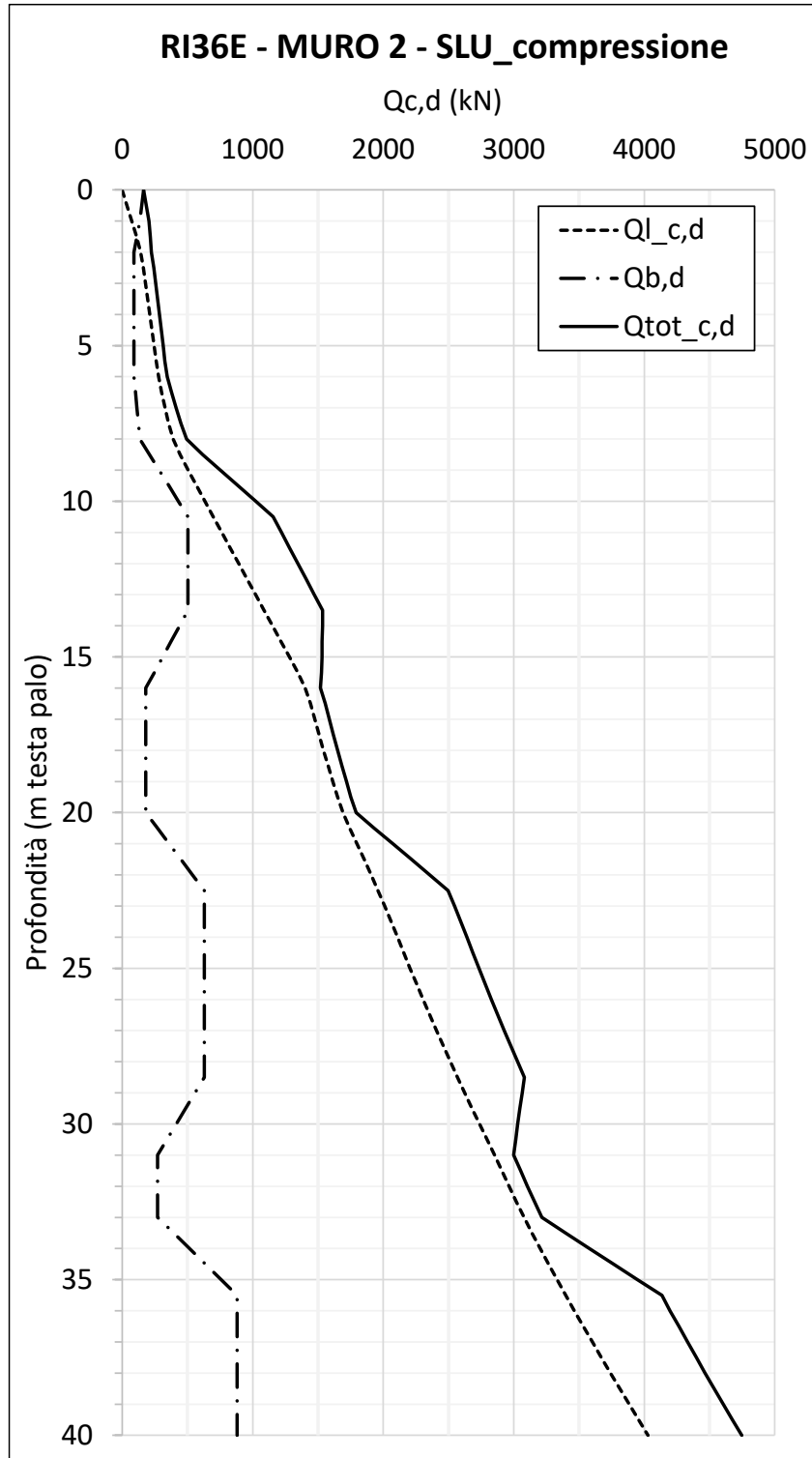
Figura 75– Curve di resistenza di progetto SLU, compressione per pali D=800 mm
