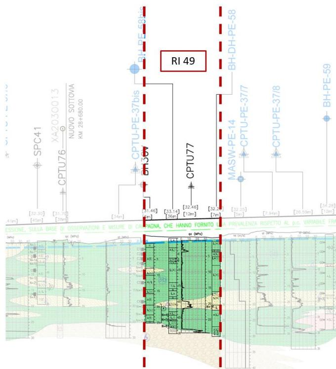
Figura 5 - Profilo Geotecnico Rilevato RI49, estratto dal Profilo Geotecnico Generale (Doc. Rif. [3])
