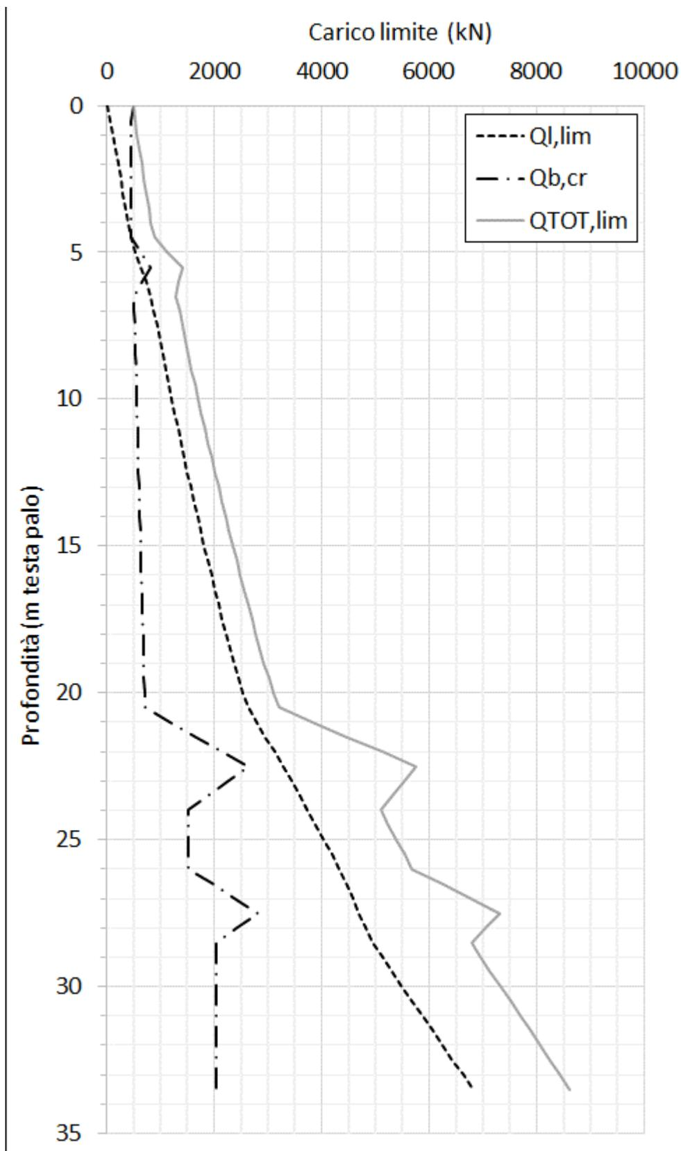
Figura 33 – Curve di Carico Limite Ultimo per pali D=1200 mm
