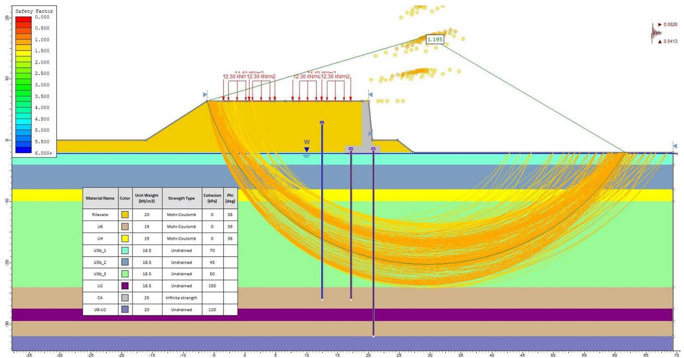
Figura 21 – Rilevato RI 58 - Analisi SLU in campo sismico
