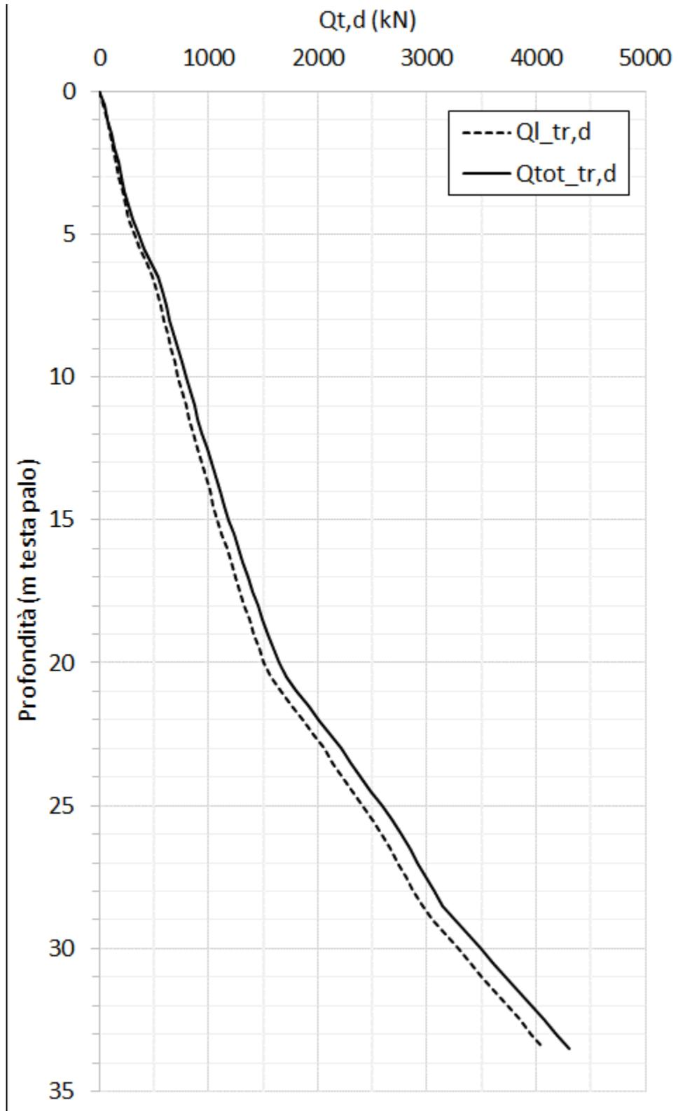
Figura 35 – Curve di capacità portante SLU, trazione per pali  $D=1200$  mm
