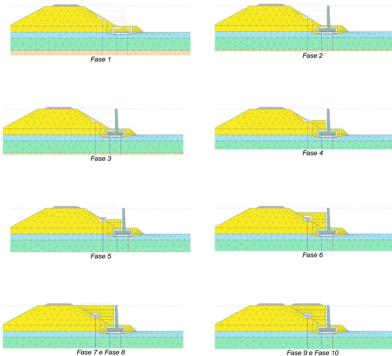
Figura 24 – RI58: fasi della modellazione a elementi finiti
