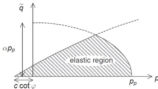
Figura 22 – Superficie di snervamento del modello Hardening Soil nel piano  $q-p'$
