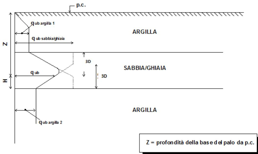
Figura 31 - Criterio di valutazione della pressione ultima di base ( $q_{ub}$ ) in terreni stratificati
