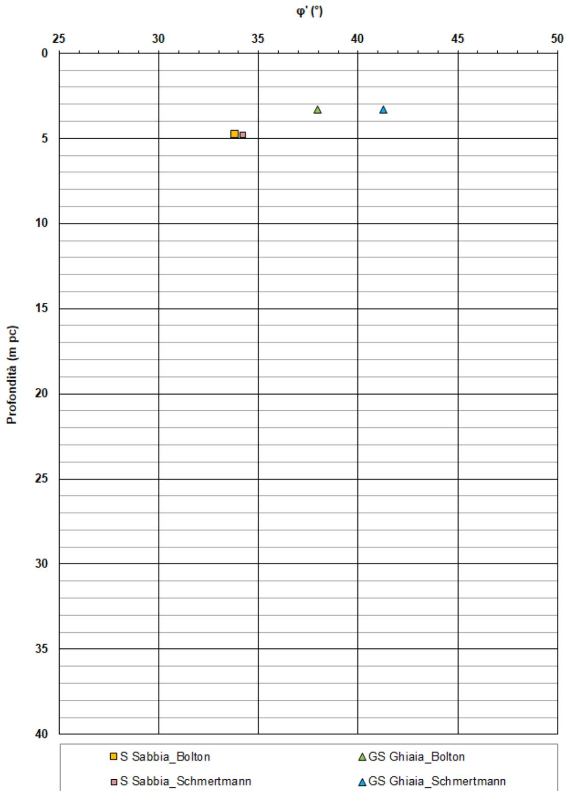
Figura 12 – Angoli di resistenza al taglio da prove SPT nell'area di interesse
