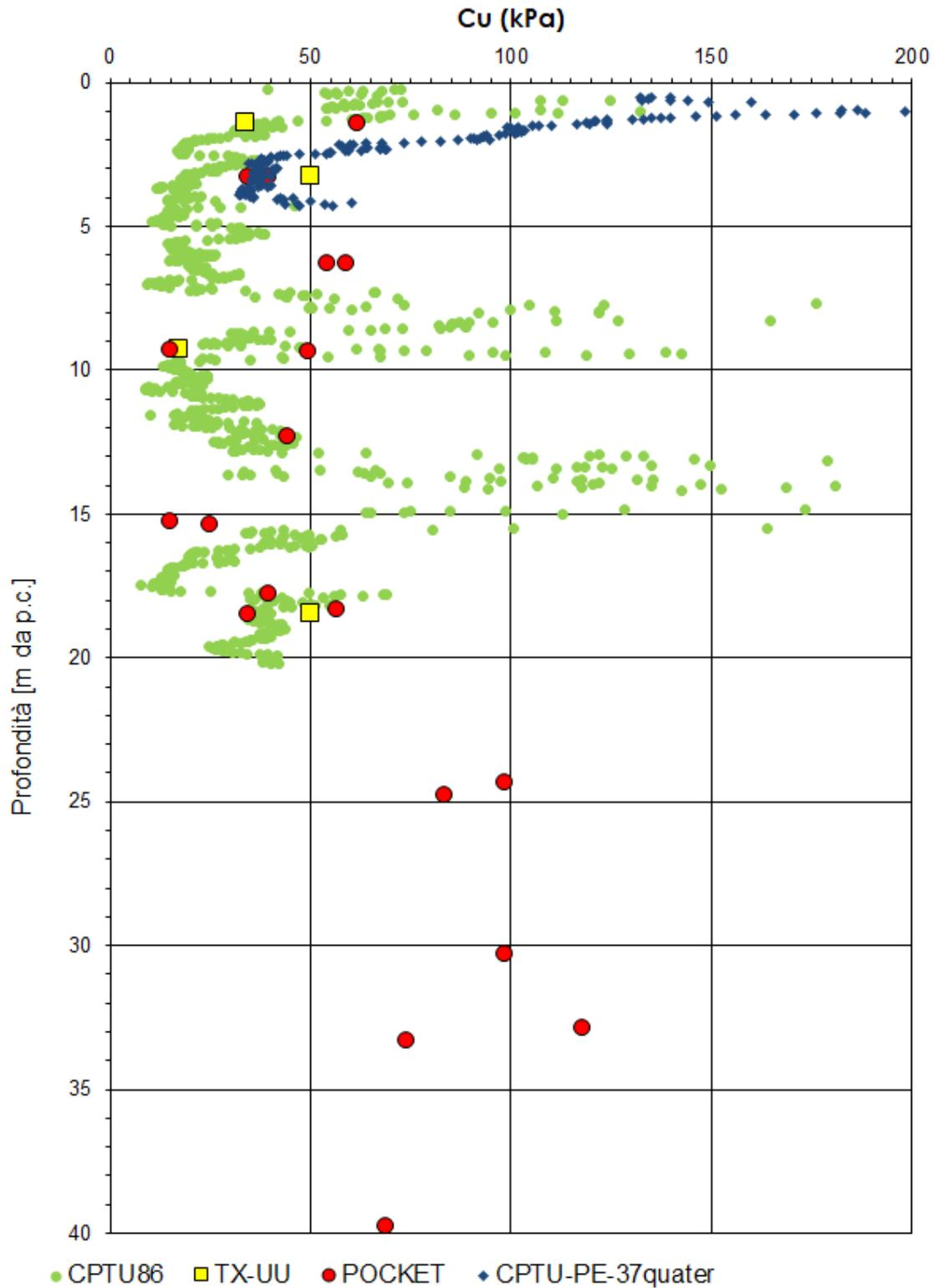
Figura 9 – Resistenza in condizioni non drenate da prove CPTU disponibili nell'intorno della WBS
