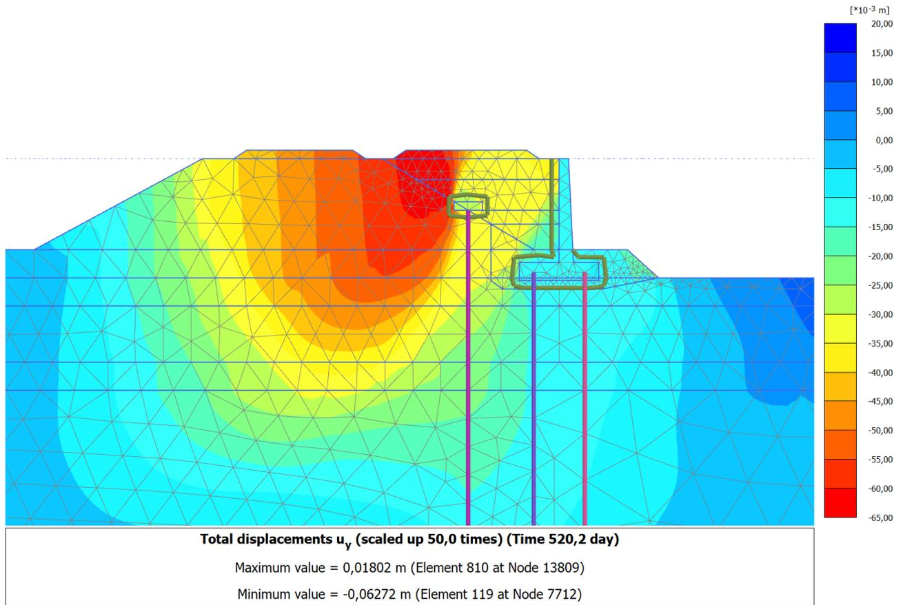
Figura 25 – RI 58: Cedimenti totali al termine della costruzione del rilevato ferroviario AV
