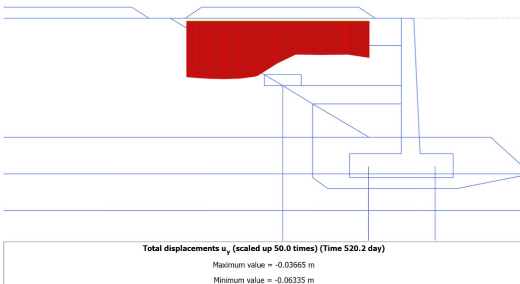
Figura 27 – RI 58: Cedimenti totali di lungo termine: al termine della consolidazione
