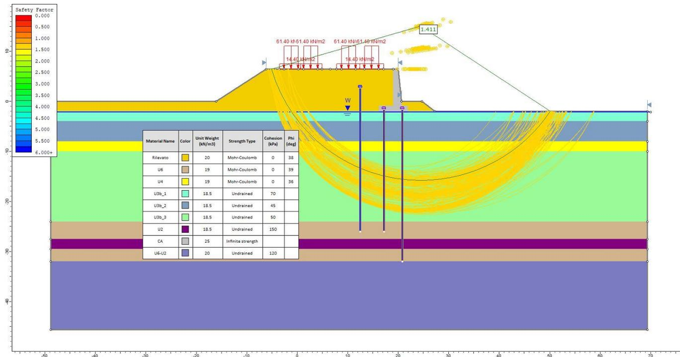
Figura 20 – Rilevato RI 58 - Analisi SLU in campo statico DA1C2
