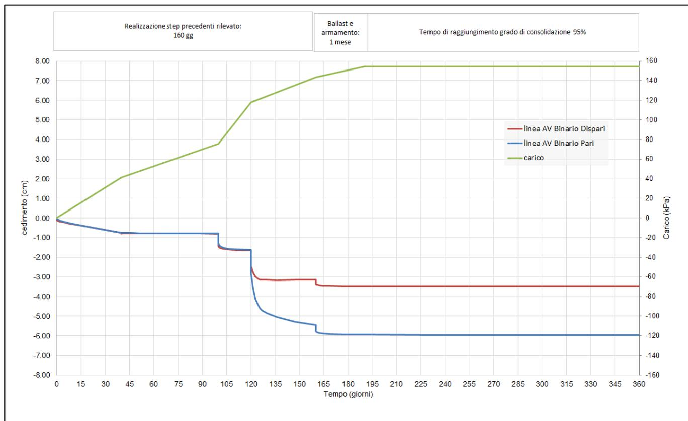
Figura 30 – RI 58: Sviluppo nel tempo dei cedimenti totali alla base del rilevato di progetto (linee rossa e blu) in funzione del carico alla base del rilevato (linea verde)
