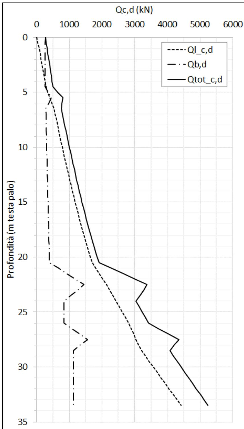
Figura 34 – Curve di capacità portante SLU, compressione per pali  $D=1200$  mm
