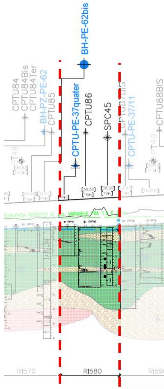
Figura 4 - Profilo Geotecnico Rilevato RI58, estratto dal Profilo Geotecnico Generale (Doc. Rif. [3])
