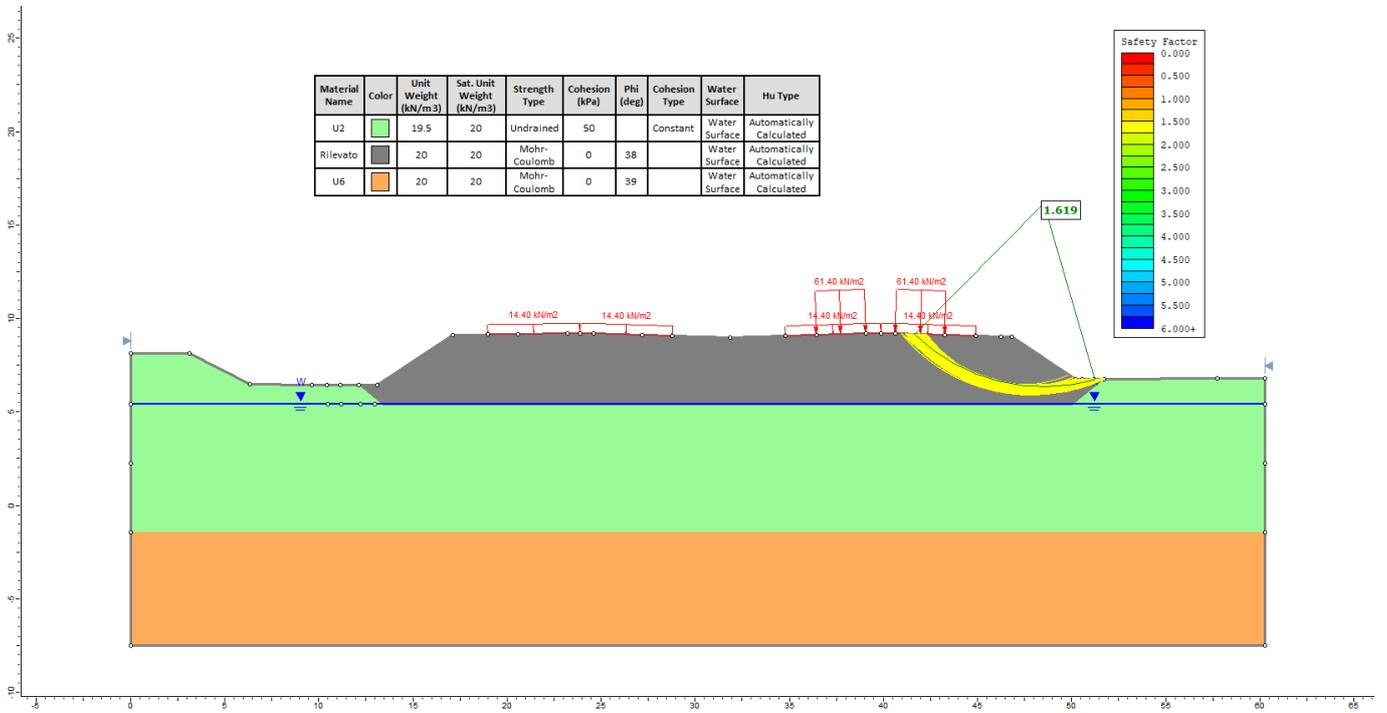
Figura 16 - Rilevato sezione n° 18 (pk 36+400,00) - Analisi SLU in campo statico DA1C2
