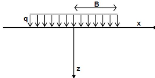
Figura 18 – Modello di calcolo Settle 3D – carico uniforme
