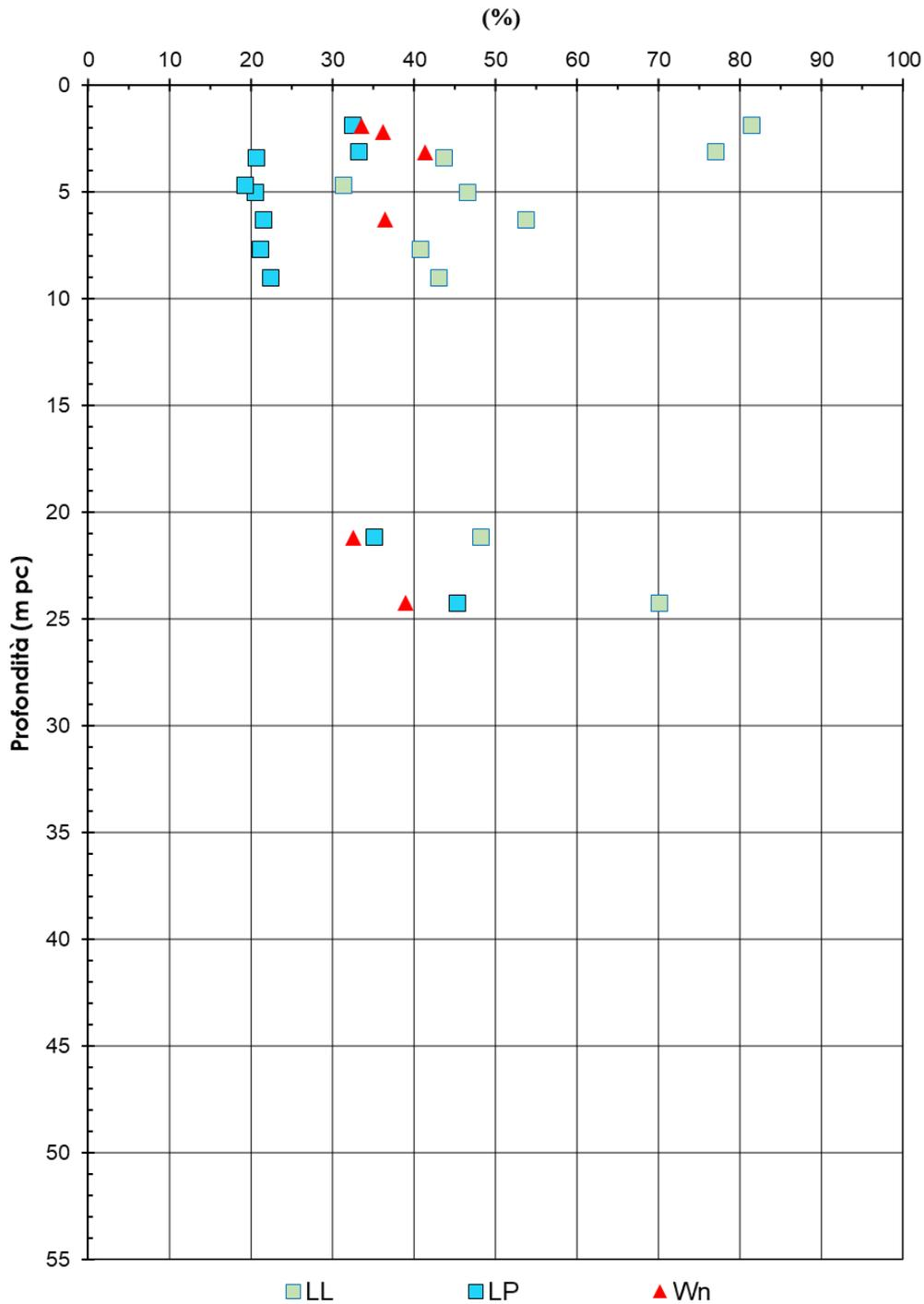
Figura 8 – Contenuto d'acqua, limite liquido e limite plastico - RI68a (pk 36+000 ÷ 36+543,71)
