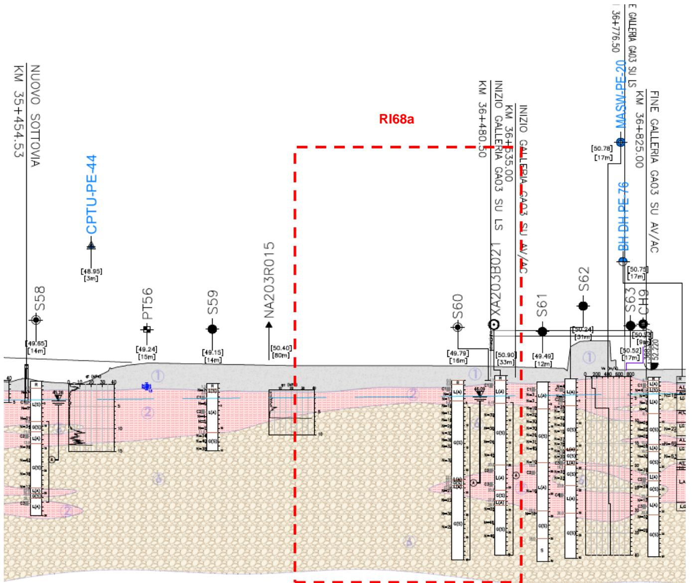
Figura 3 - Profilo Geotecnico Rilevato R168a, estratto dal Profilo Geotecnico Generale (Doc. Rif. [5])
