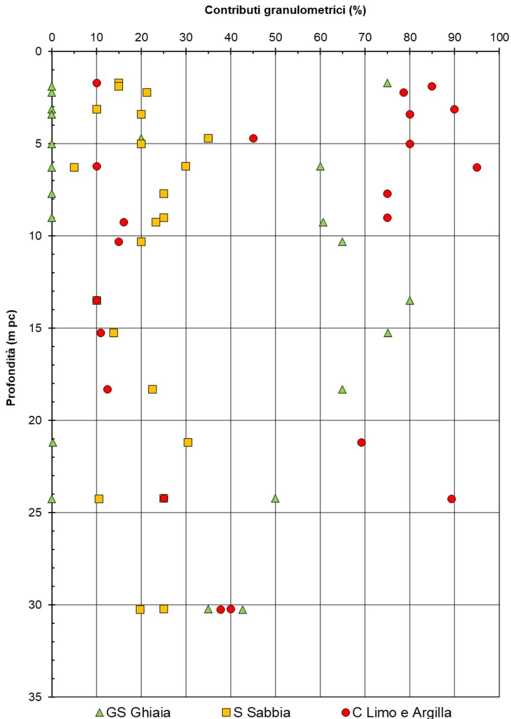
Figura 4 – Sintesi analisi granulometriche – RI68a (pk 36+000 ÷ 36+543,71)
