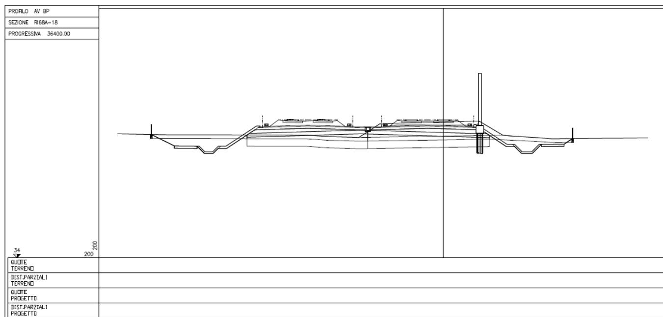
Figura 1 – Sezione di riferimento n° 18 (pk 36+400,00) estratta da sezioni PE (Doc Rif. [1])
