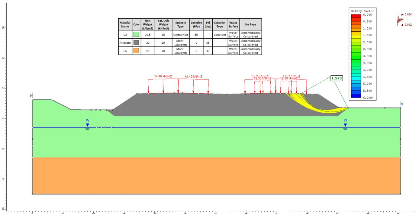
Figura 17 - Rilevato sezione n° 18 (pk 36+400,00) - Analisi SLU in campo sismico
