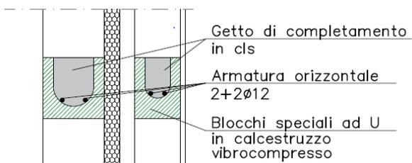
I cordoli orizzontali sono armati con  $2\phi 12 + 2\phi 12$  come da figura sopra.
