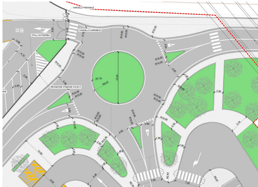
Figura 40 - Nuova viabilità di accesso alla stazione
