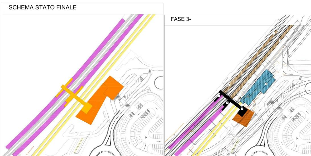
In questa fase le banchine saranno completate ed operative lato sud, il sottopasso di collegamento sarà completamente operativo così come la parte sud dell'edificio viaggiatori. Sono da coordinare le fasi di demolizione della parte sud dell'edificio esistente in modo da limitare il più possibile le interferenze tra i due cantieri.
