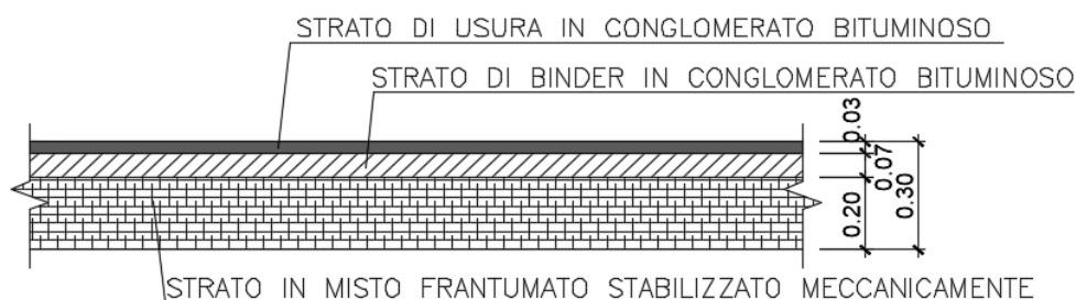
Figura 4: pavimentazione di progetto
