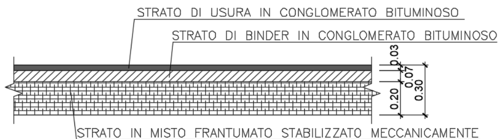
Figura 4: pavimentazione di progetto
