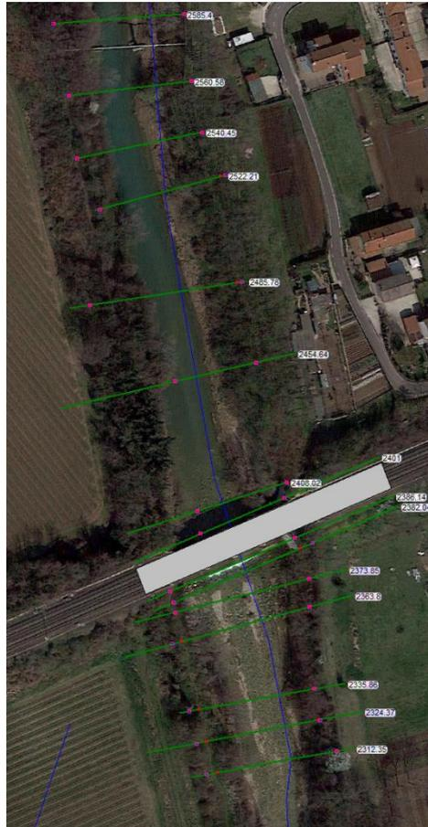
Figura 10-11 Planimetria di modellazione del Fiume Guà, fase di cantierizzazione, zoom nella zona di intervento
