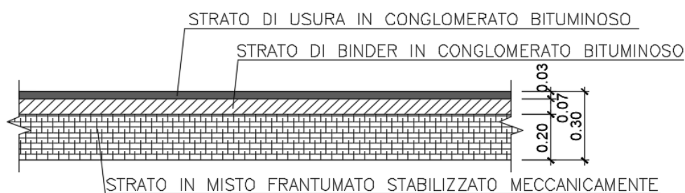
Figura 4: pavimentazione di progetto
