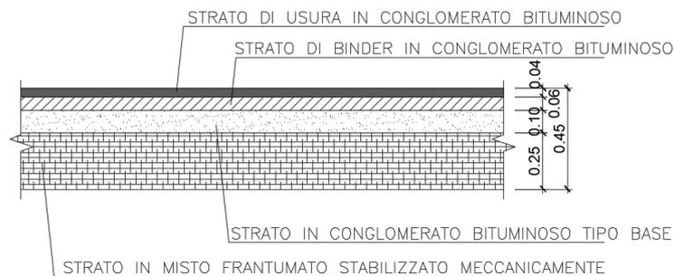
Figura 4: pavimentazione di progetto (F e E)
