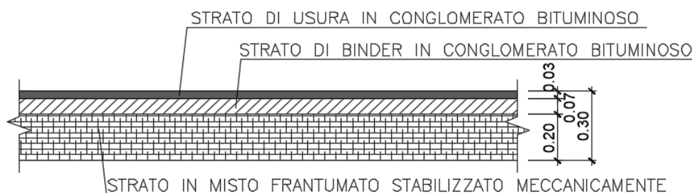
Figura 4: pavimentazione di progetto
