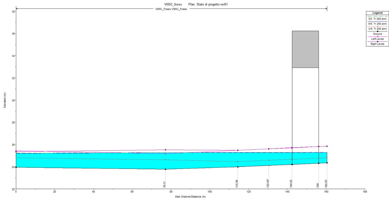
Figura 10-6 Profilo di modellazione del fosso alla pk 20+886, post operam
