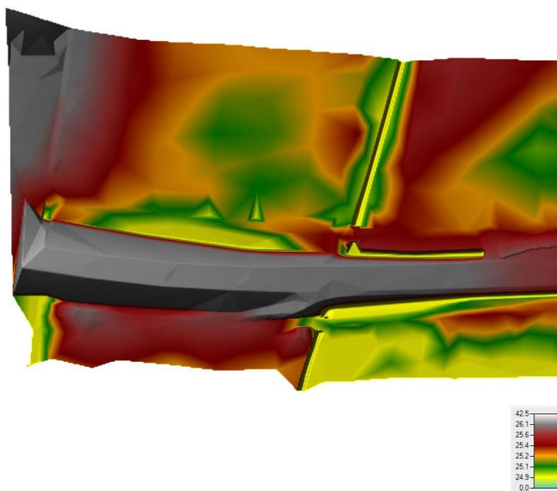
Figura 7-3 DTM ricavato da rilievo topografico (i valori riportati sono in m s. m.).
