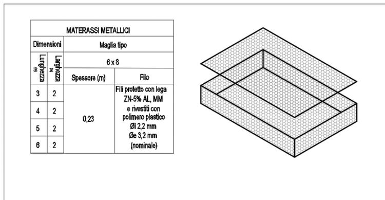
Figura 8-3 Dettaglio materassi tipo Reno
