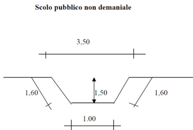
Figura 7-1 Sezione del fosso alla pk di progetto 20+886 (fonte: Consorzio di bonifica Alta pianura Veneta)
