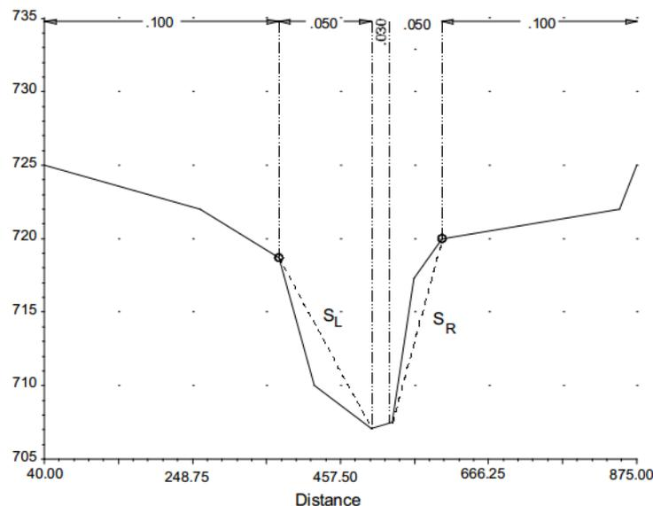
Figura 10-1 Schema per il calcolo della scabrezza equivalente
