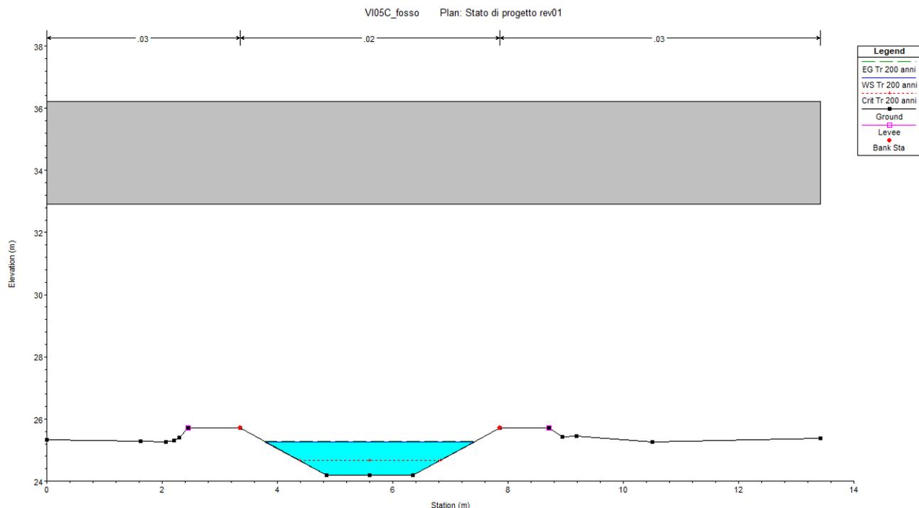
Figura 10-7 Sezione tipo post operam estratta da HEC-RAS
