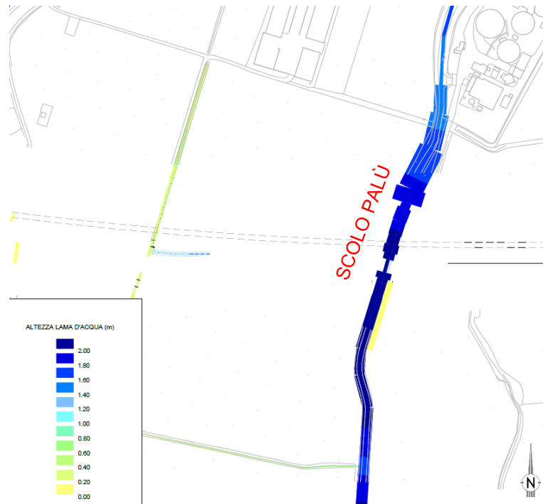
Figura 10-11 Aree di esondazione ante operam, relativa alla zona dello scolo Palù; gli allagamenti sono causati sia dall'idrografia principale sia dall'idrografia secondaria;
