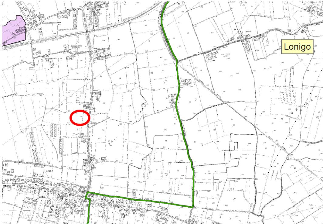
Fig. 5.1: Estratto della tavola 65 del PAI del fiume Brenta-Bacchiglione con perimetrazione delle aree a diverso grado di pericolosità idraulica.
