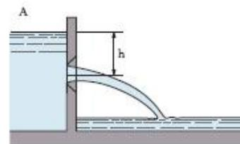
Una volta individuato il bacino afferente si calcola la massima portata scaricabile e con la formula appena descritta si ricava il valore del diametro della luce effluente.
