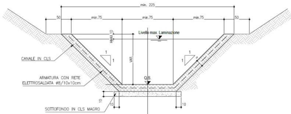
Figura 3 – Sezione tipologia dei fossi di laminazione.
