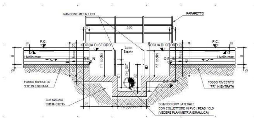
Figura 5 – Sezione tipologica dei manufatti di regolazione e scarico tipo “MC3”.
