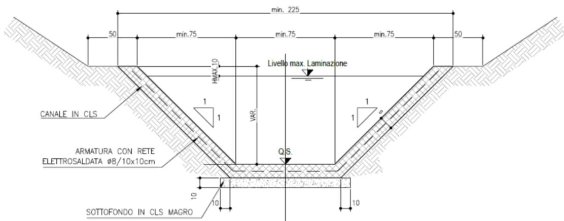
Figura 4 – Sezione tipologia dei fossi di laminazione.
