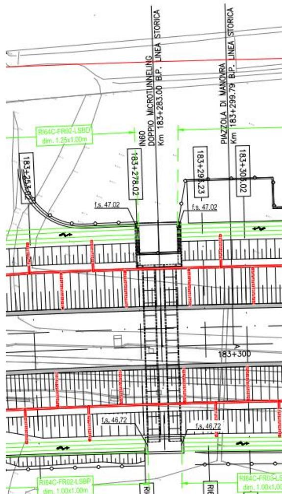
Figura 2 – Attraversamento del rilevato della L.S. tramite il tratto in doppio microtunneling della WBS IN60
