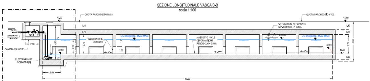
Figura 5 - Sezione della vasca di laminazione e sollevamento
