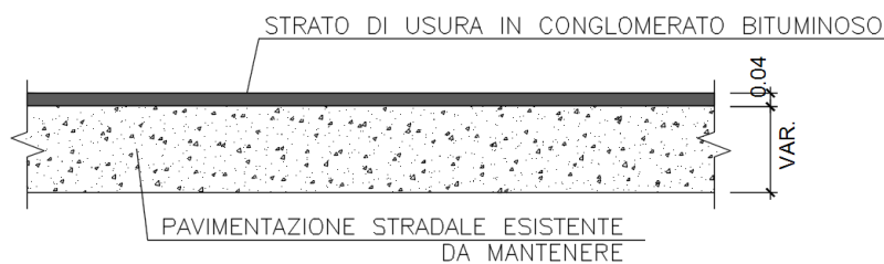
Figura 7: Pacchetto pavimentazione Via Campagnole lato ovest
