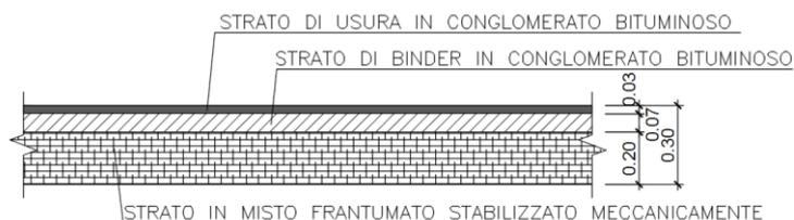
Figura 4: Pacchetto pavimentazione
