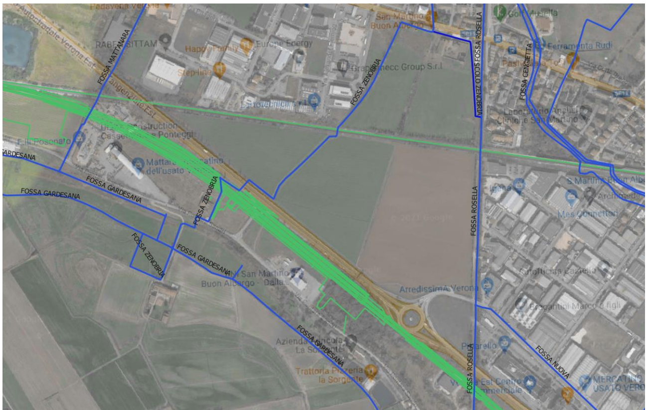
Figura 2 – Immagine satellitare dell'area oggetto di studio con sovrapposizione del tracciato ferroviario di progetto e reticolo idrico attuale della Fossa Zenobria (fonte: Fonte: Arpa Veneto/grafico idrografia)
