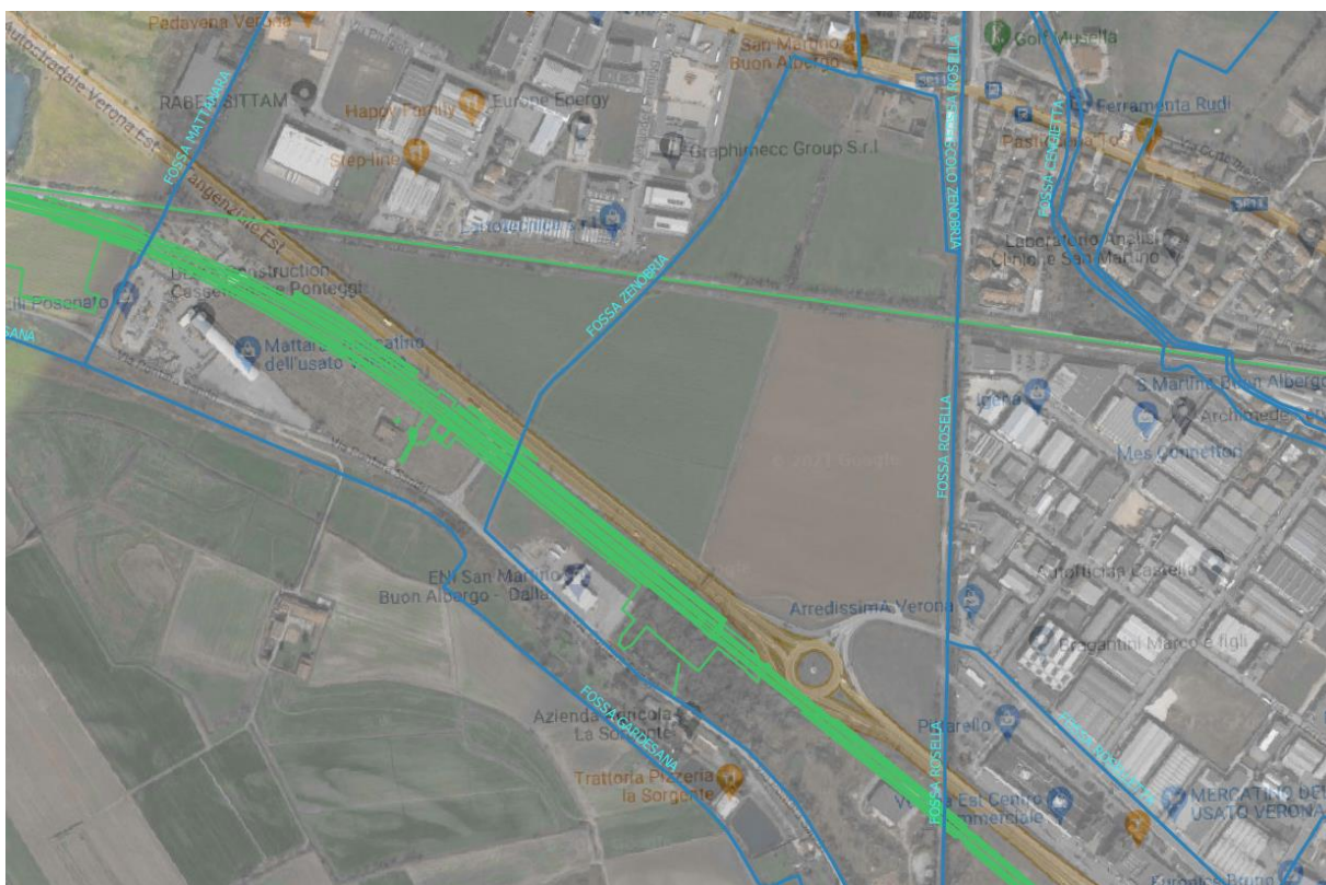
Figura 1 – Immagine satellitare dell'area oggetto di studio con sovrapposizione del tracciato ferroviario di progetto e reticolo idrico originale della Fossa Zenobria (fonte: Fonte: Arpa Veneto/grafico idrografia)
