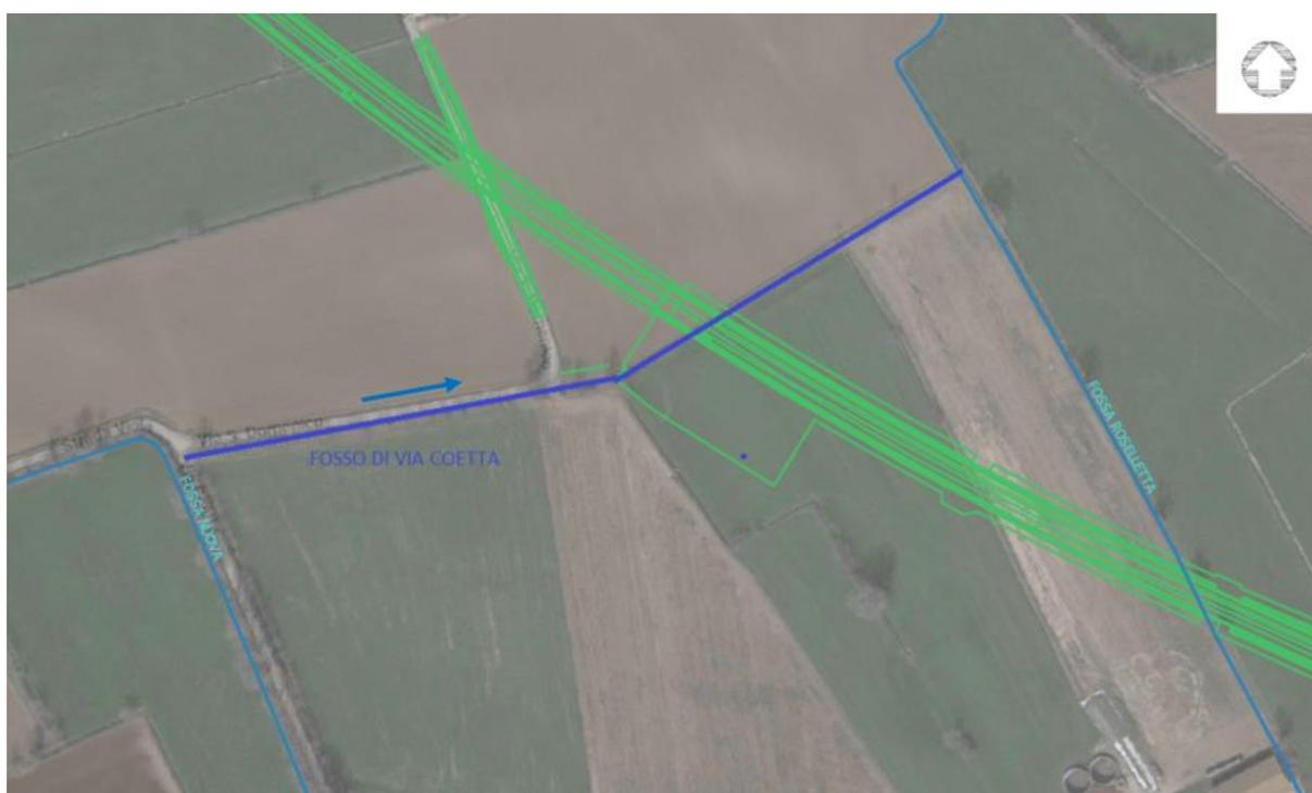
Figura 1 – Immagine satellitare dell'area oggetto di studio con sovrapposizione del tracciato ferroviario di progetto e reticolo idrico (fonte: Fonte: Arpa Veneto/grafico idrografia)
