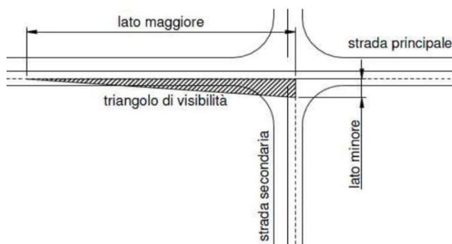
In particolare, il lato maggiore del triangolo di visibilità viene rappresentato dalla distanza di visibilità principale  $D$ , data dall'espressione:
