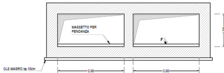
Figura 8 – Sezione tipo del doppio scatolare di progetto
