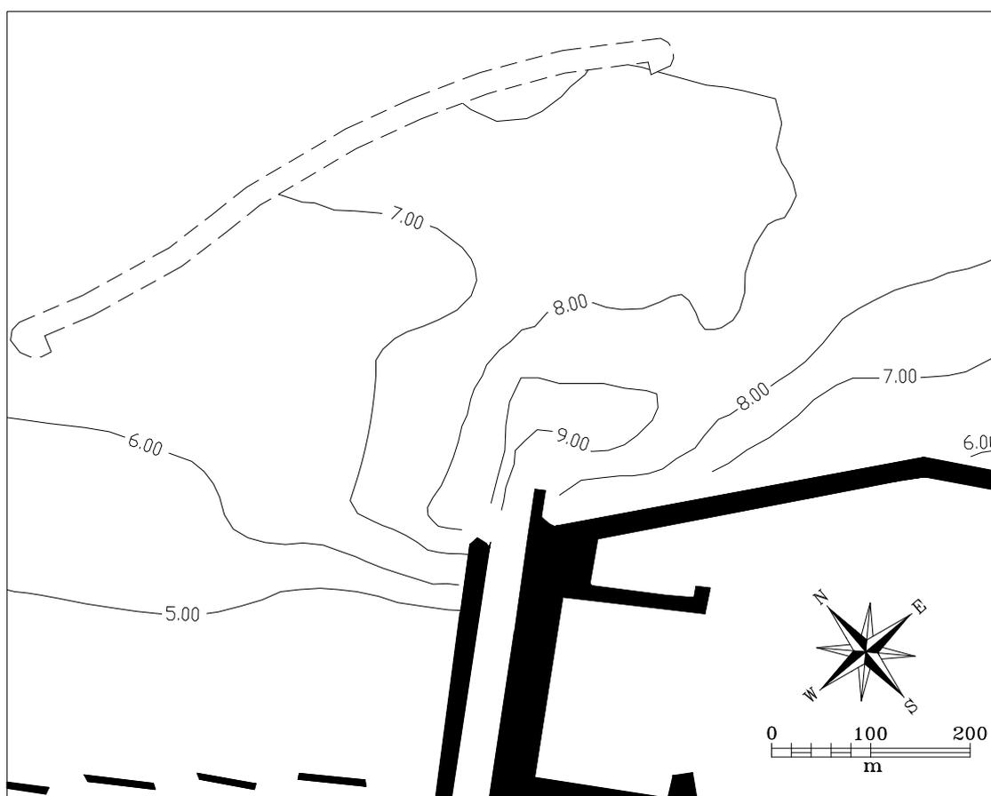
**Figura 4.2 - Batimetria dell'avamporto rilevata nel 1987.**
