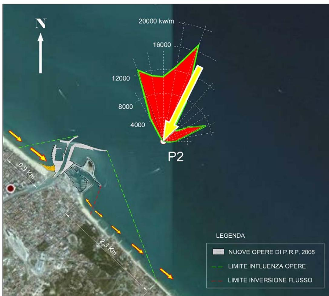
Figura 5.2 – Andamento delle componenti longitudinali dei vettori del flusso di energia in prossimità delle opere del porto di Pescara.
