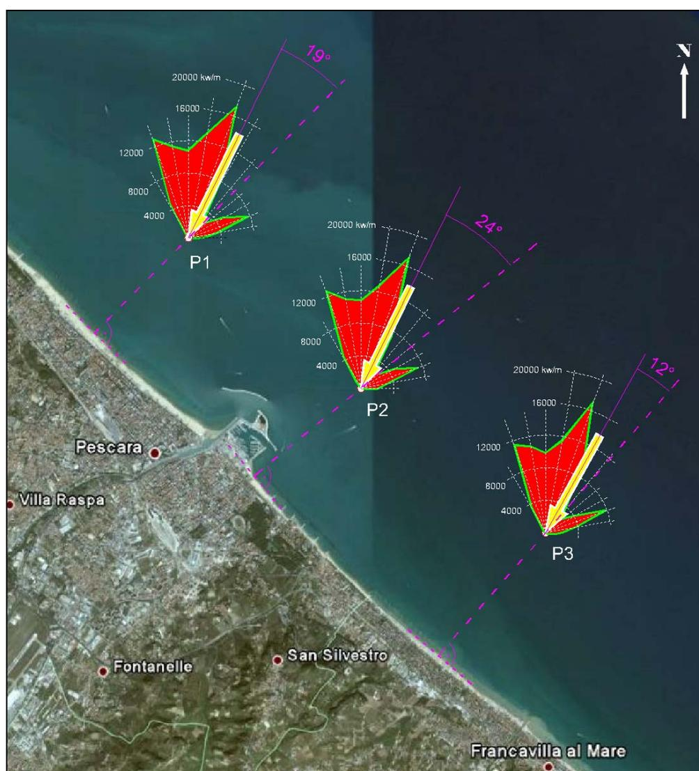
Figura 3.3 - Diagramma polare e risultante del flusso di energia valutato nei tre punti in esame.
