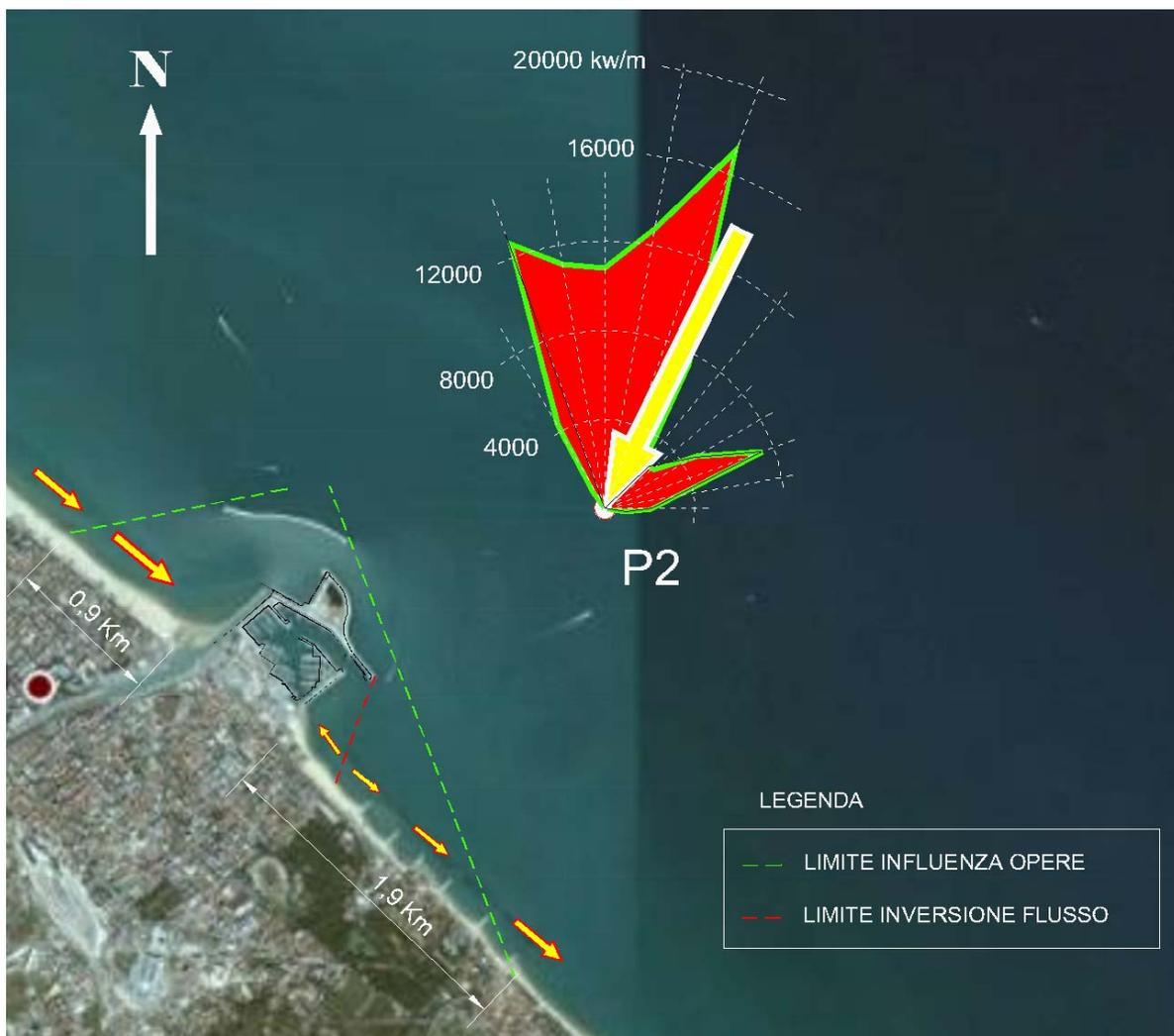
Figura 3.7 - Situazione attuale: andamento delle componenti longitudinali dei vettori del flusso di energia lungo la costa.
