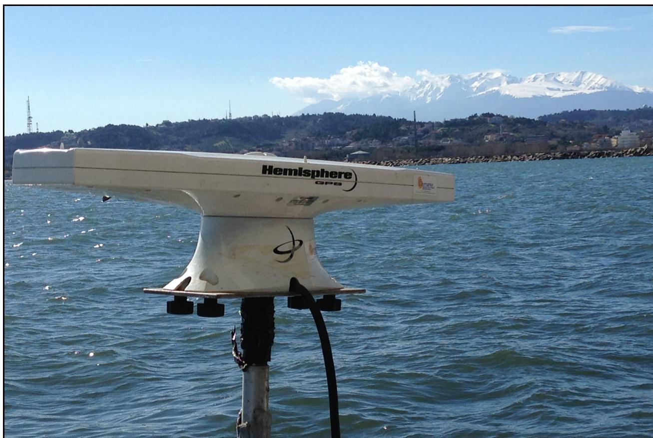
Figura 7. Antenna del sistema GPS Compass Hemisphere v101
