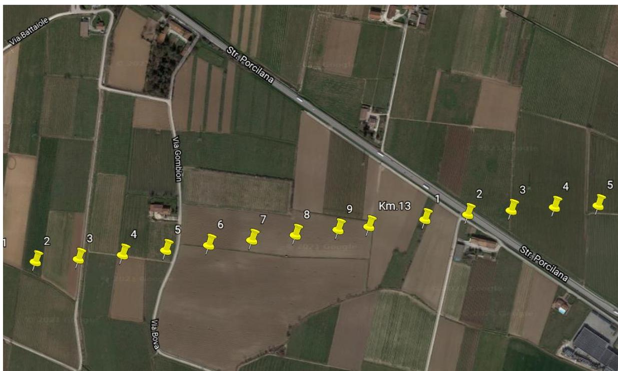
Il tracciato planimetrico della linea AV/AC lungo il rilevato è in rettilineo, mentre il tracciato altimetrico prevede una livelletta che scende con pendenza 0.091%.
