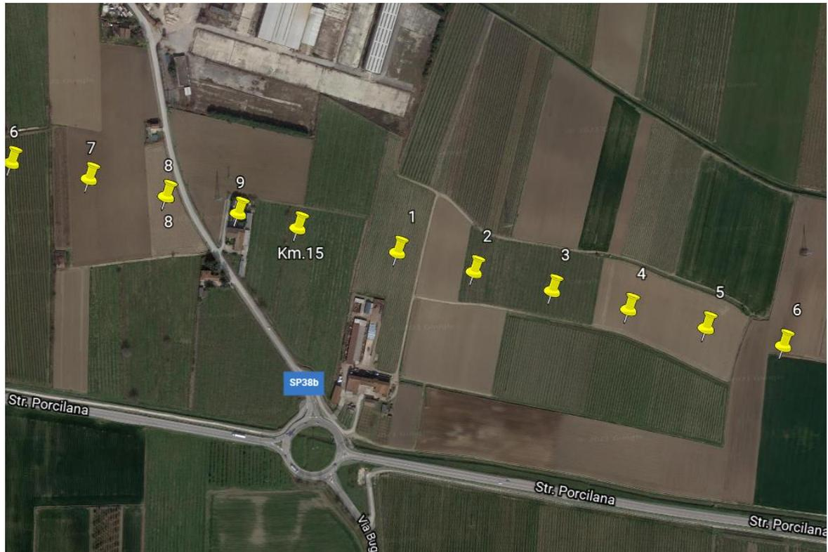
Il tracciato planimetrico della linea AV/AC lungo il rilevato è in rettilineo fino al km 15+395.654, dove ha inizio una clotoide e successiva curva (raggio  $R=12000\text{m}$ ) che prosegue fino al termine del rilevato.
