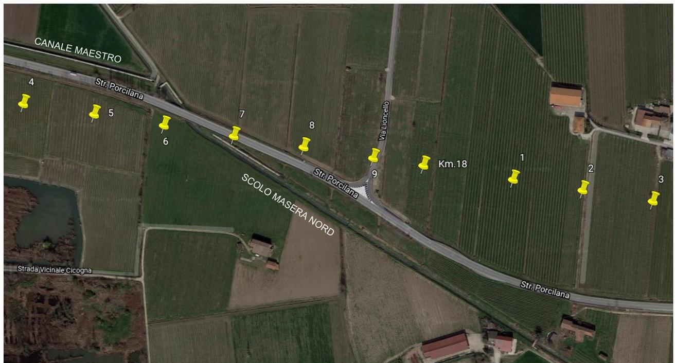
Il tracciato planimetrico della linea AV/AC lungo il rilevato è interamente in rettilineo, mentre il tracciato altimetrico prevede una livelletta che sale con pendenza 0.066% per tutto lo sviluppo del rilevato.
