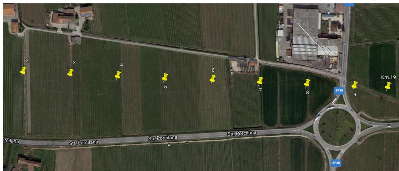
Il tracciato planimetrico della linea AV/AC lungo il rilevato è interamente in rettilineo, mentre il tracciato altimetrico prevede una livelletta che sale con pendenza 0.066% fino al km 18+281.815, dove la pendenza aumenta a 1.20%.
