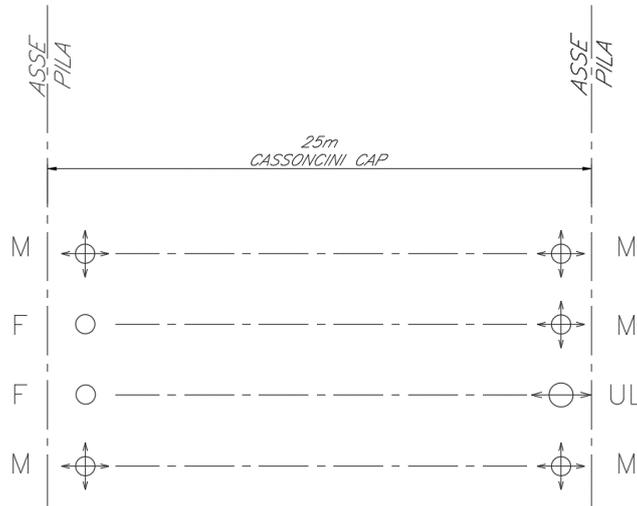
Fig. 2: Schema appoggi
