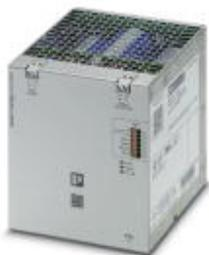
Modulo capacitivo QUINT con accumulatore di energia che non richiede manutenzione grazie al condensatore a doppio strato per montaggio su guida, ingresso: 24 V DC, uscita: 24 V DC / 10 A / 8 kJ, incl. adattatore per guida DIN universale montato UTA 107
