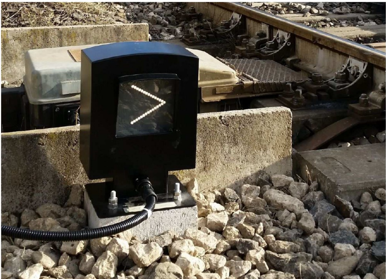
Foto 6 - SID-TM32 su basamento in laterizio
