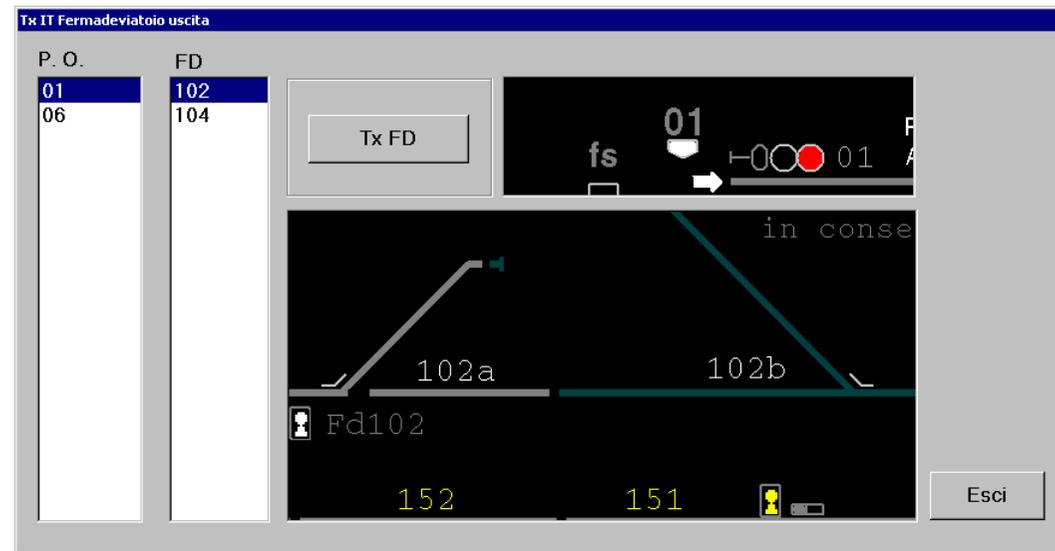
Figura 66 – Finestra Tx IT Fermadeviatioio Uscita.
