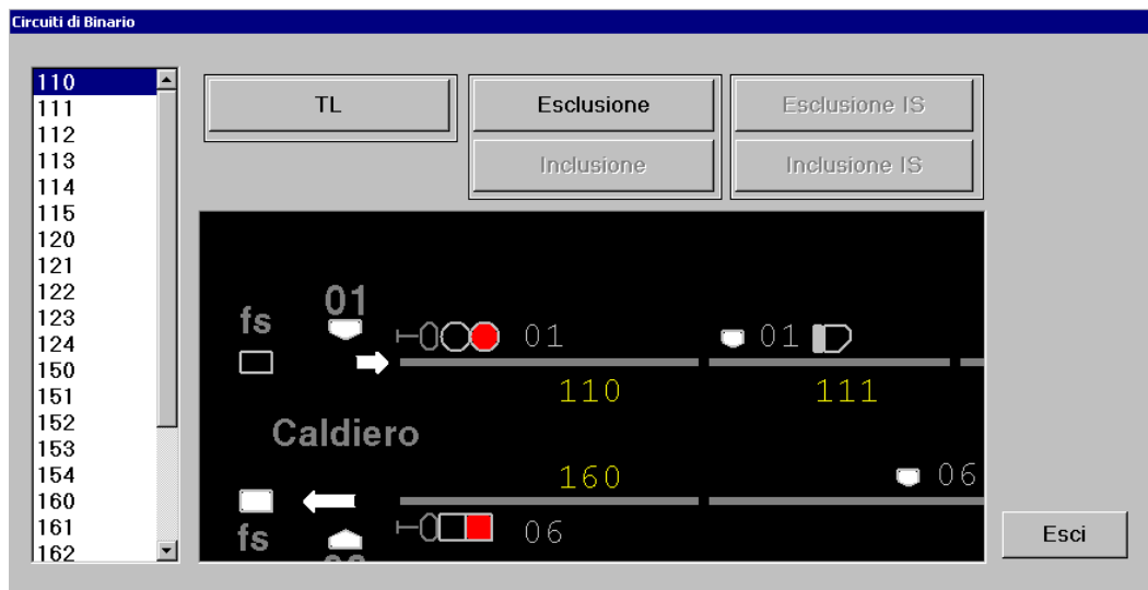
Figura 29 – Finestra comandi "Circuiti di Binario".
