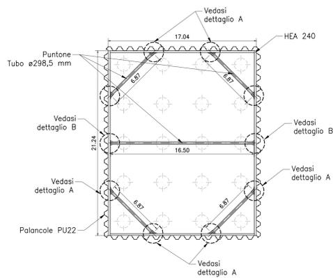
NOTA: Il sistema interno di contrasto potrà essere rimosso dopo la realizzazione del plinto di fondazione
