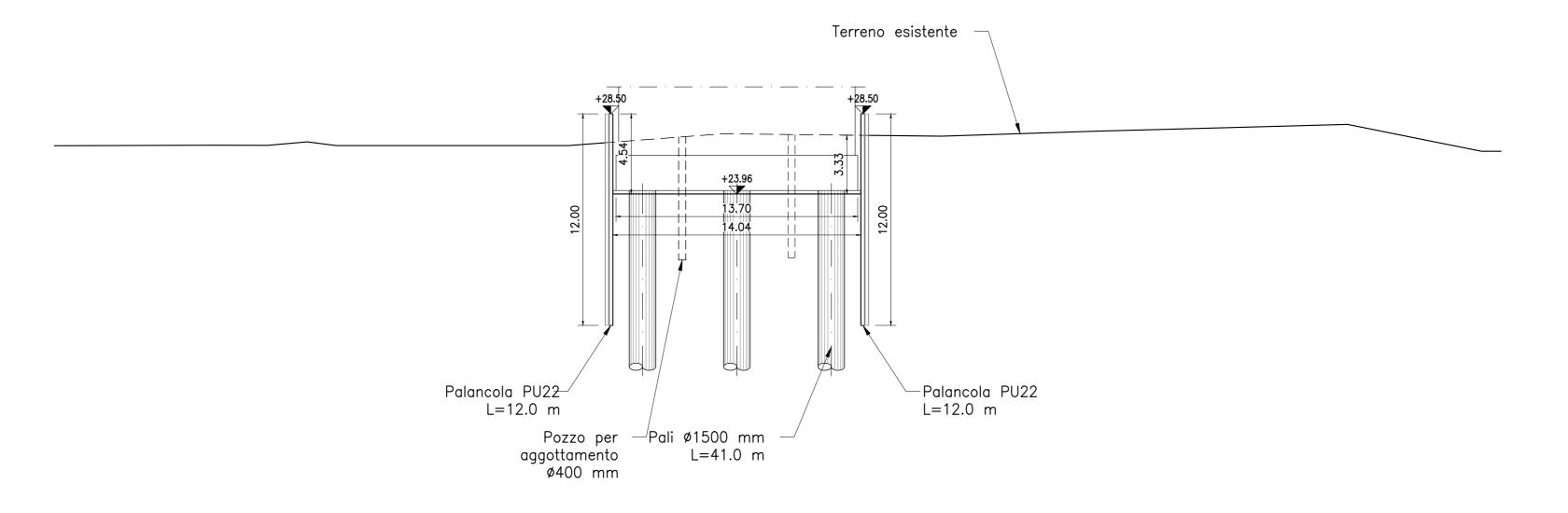
SPALLA B SEZIONE TRASVERSALE Scala 1:200
