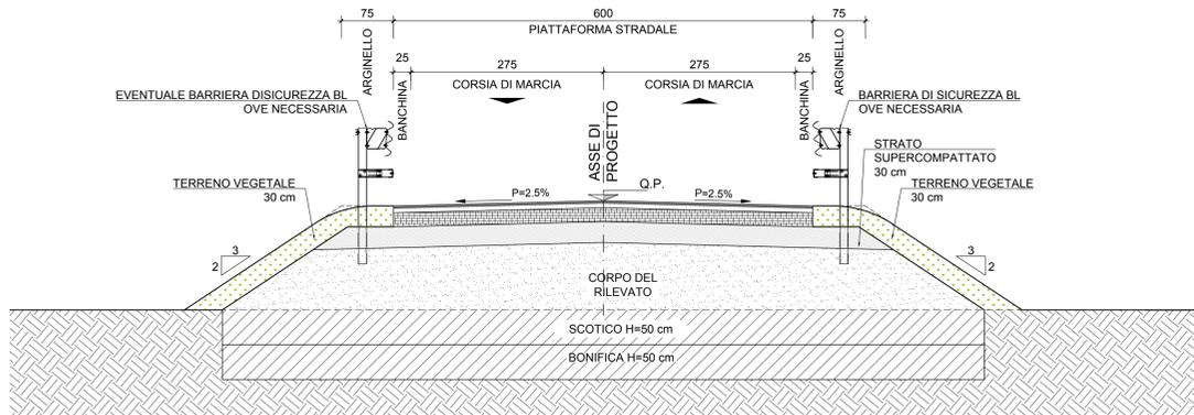
SEZIONE TIPO IN RILEVATO - STRADA VICINALE 4.00m - 1:50
