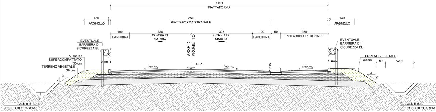
SEZIONE TIPO IN RILEVATO - 1:50
