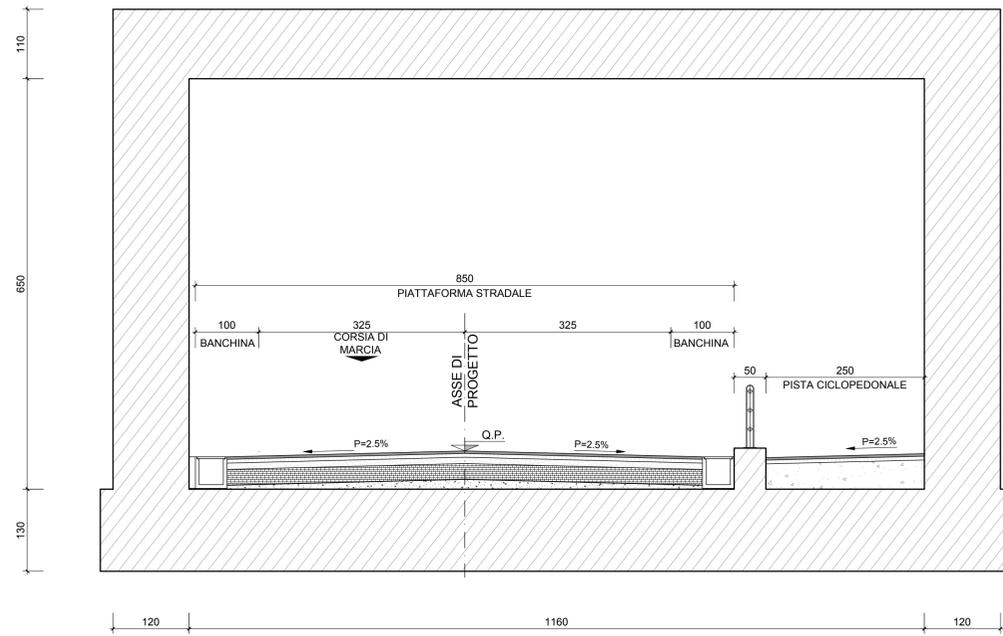
SEZIONE TIPO IN RILEVATO - 1:50
