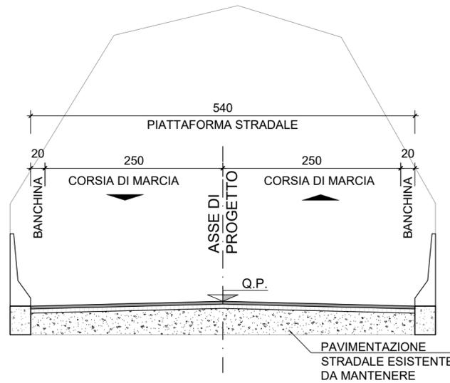
**SEZIONE TIPO SOTTOVIA DI PROGETTO - 1:50**
