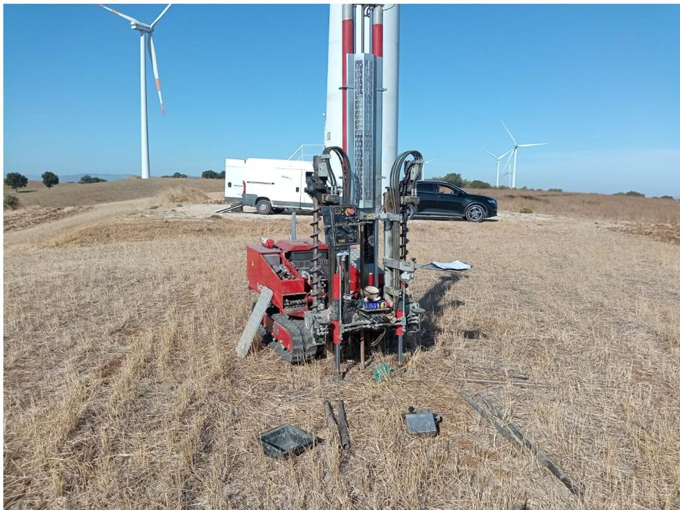
*Prova penetrometrica dinamica pesante DPSH 01*
