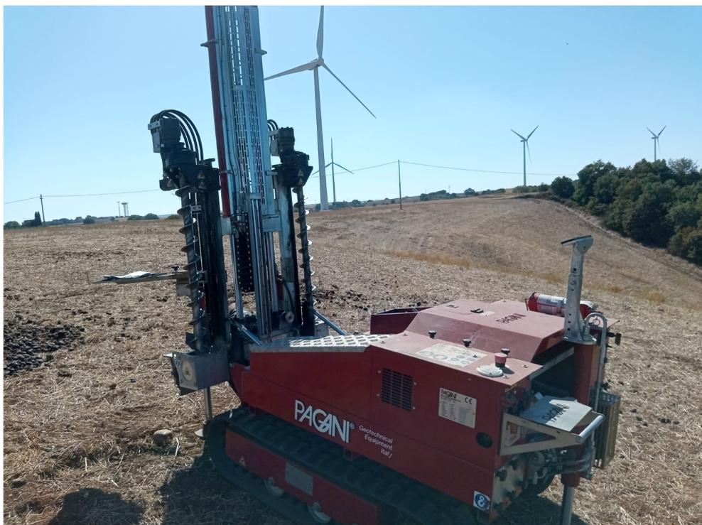
*Prova penetrometrica dinamica pesante DPSH 03*
