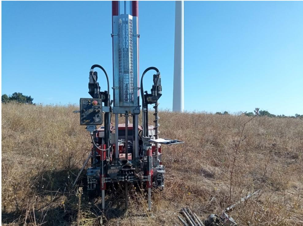
*Prova penetrometrica dinamica pesante DPSH 02*
