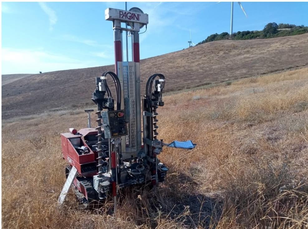
*Prova penetrometrica dinamica pesante DPSH 05*
