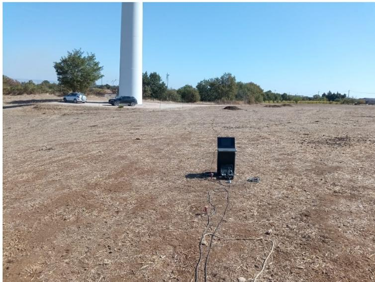
*Indagine sismica di superficie Masw M2 – Aerogeneratore RGT 03*
