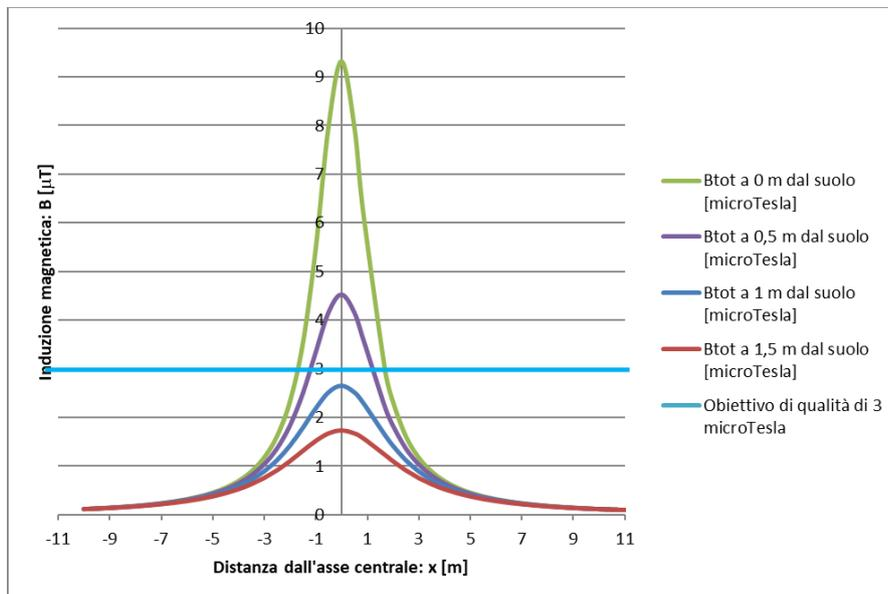
Figura 3: Andamento del campo magnetico generato dal cavidotto, composto da quattro terne da 630 mm<sup>2</sup>
