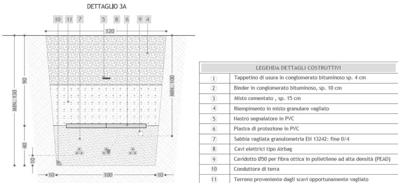
Figura 2: Sezione tipo cavidotto MT composta da tre terne da 630 mm<sup>2</sup>
