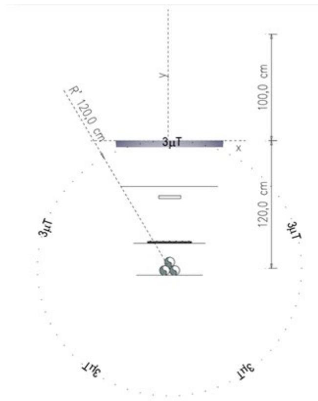
Figura 3 - schema posa a trifoglio cavo MT 30 kV
