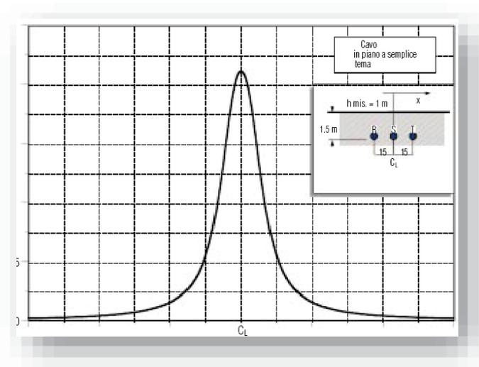
Figura 1 - Profilo campo magnetico di una terna piana MT
