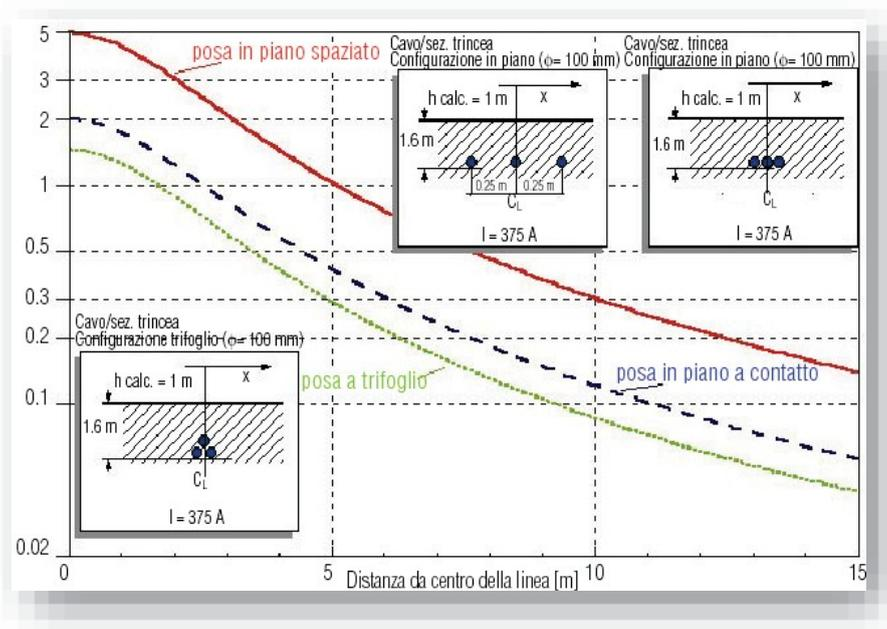
Figura 2 - Profili a confronto tra configurazioni interrate
