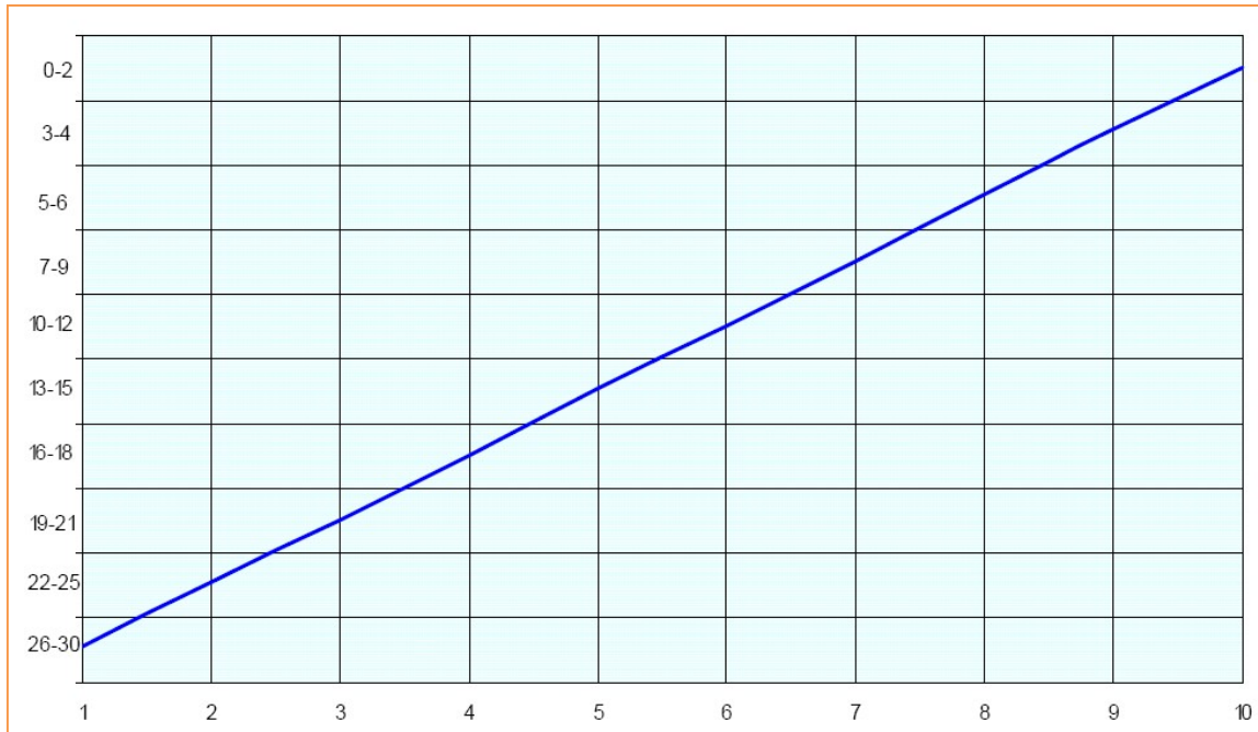
Correlazione tra l'inclinazione del terreno espressa in % (ordinata) ed il relativo punteggio S.I.N.T.A.C.S.
