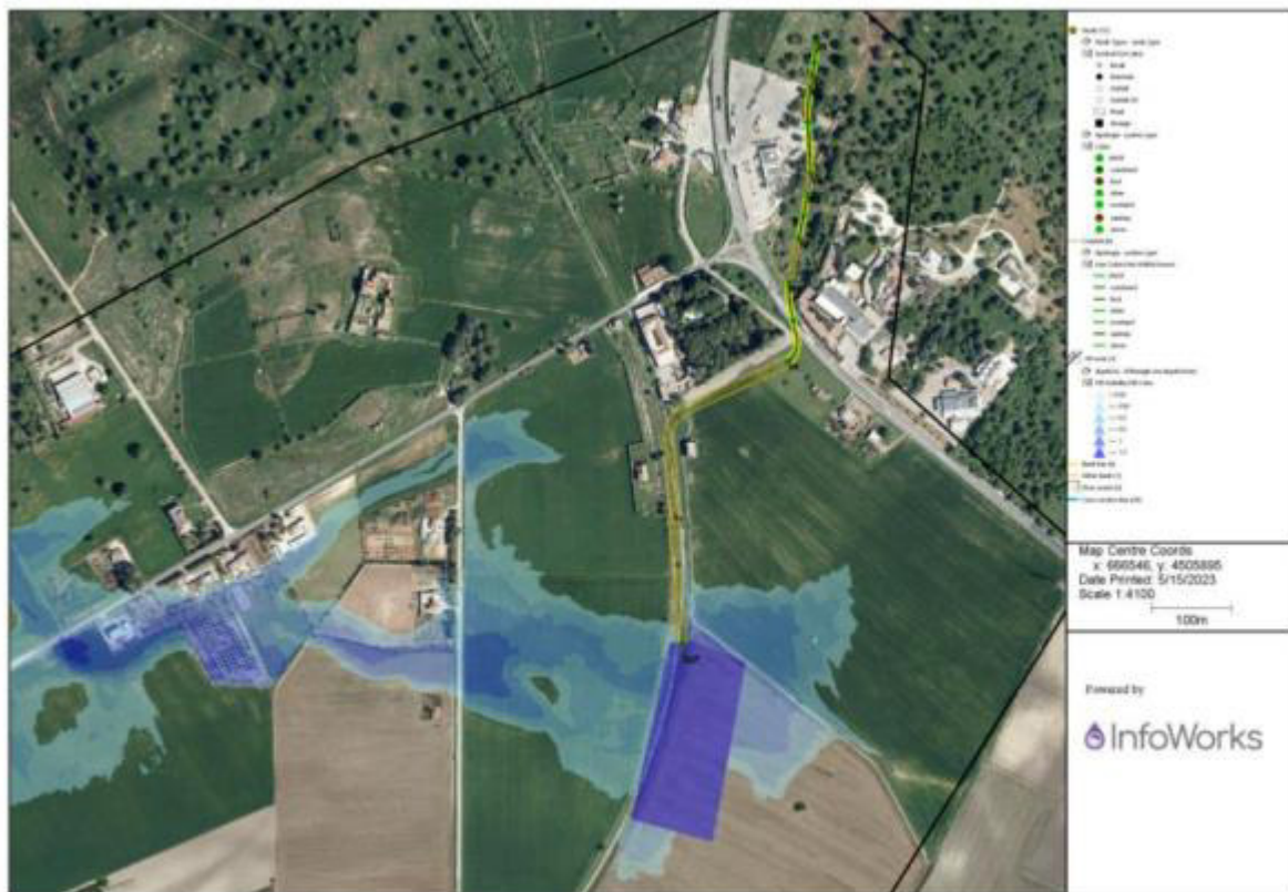
Figura 7.2.2-2: Mappa delle aree allagabili per T_r=200 anni, post operam da simulazione di progetto
