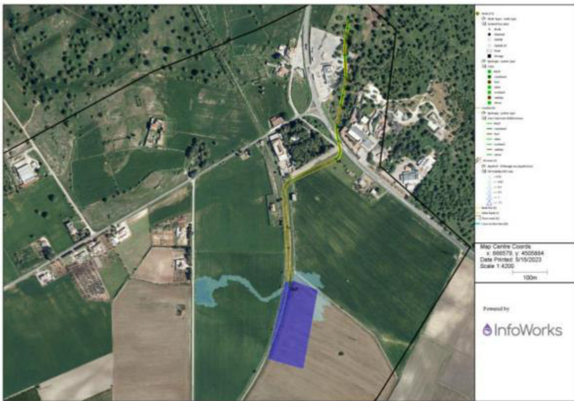
Figura 7.2.2-3: Mappa delle aree allagabili per T_r=30 anni, post operam da simulazione di progetto
