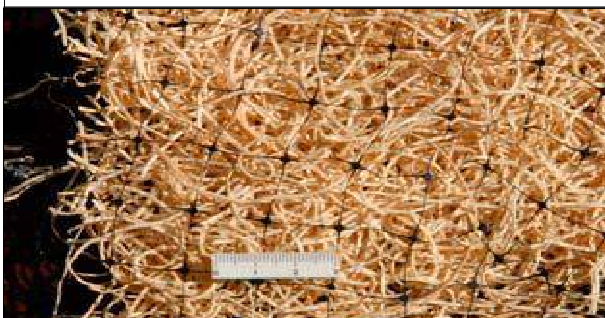
Biofiltro in fibre di paglia contenuto da rete in materiale sintetico degradabile
