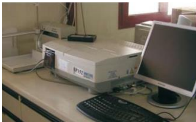
Spettrofotometro per l'analisi colorimetrica del fosforo assimilabile
