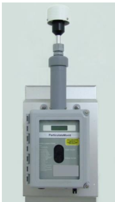
Sonda per le polveri sottili in atmosfera
